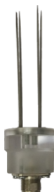
(código: HF2) sonda de agulhas de 100 mm para madeixas ou fitas cortadas
